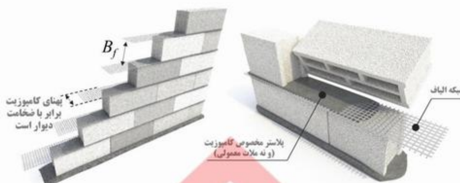
شکل ۳-۳ کمیت‌های مورد نیاز برای محاسبه ظرفیت خمشی افقی دیوارهای بنایی مسلح به کامپوزیت شبکه الیاف در بند بستر.
