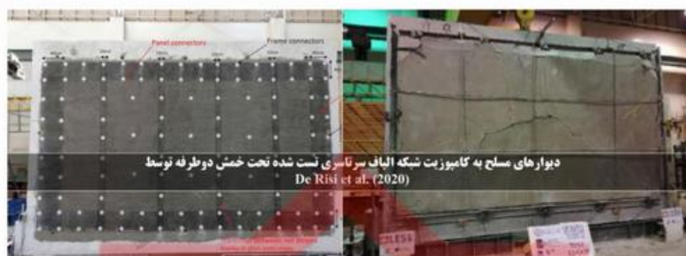
شکل پ-۹-۲ آزمایش‌های انتخابی جهت بررسی دقت رابطه تخمین ظرفیت خارج از صفحه دیوارهای مسلح به شبکه الیاف سراسری تحت خمش دوطرفه.
