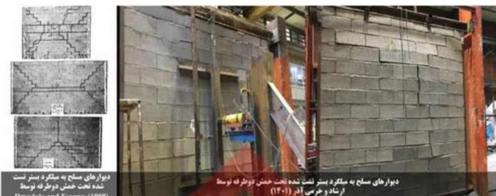
شکل پ-۲-۸ آزمایش‌های انتخابی به منظور بررسی دقت رابطه تخمین ظرفیت خارج از صفحه دیوارهای مسلح به میلگرد بستر تحت خمش دوطرفه.
