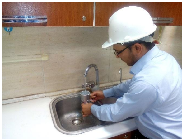
شکل شماره ۶- اندازه گیری میزان جریان خروجی تجهیزات توسط مهندسين ناظر مکانیک
